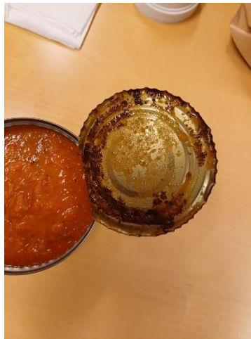
Tomaattikeitto. Tomaatti on hyvin herkkä raaka-aine. Kanteen palanut keitto on merkki liian voimakkaasta autoklavoinnista.
